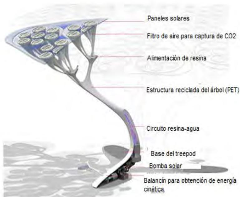
**Figura 2. Un *treepod* con todos sus componentes.**
