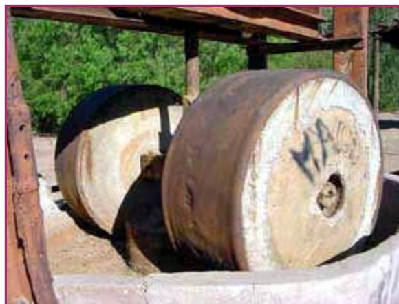
Las pesadas ruedas muelen el mineral puesto en la pileta.
